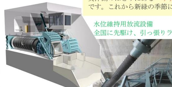
水位維持用放流設備 全国に先駆け、引っ張りラジアルゲートの採用
