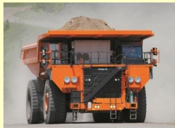
「高度車体安定化制御技術」搭載のリジッドダンプトラック EH5000AC-3
