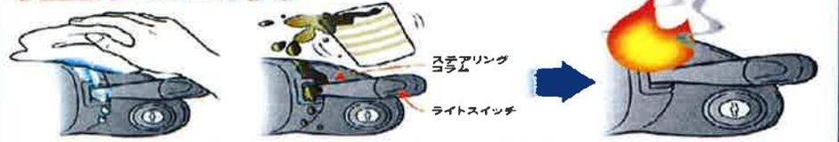
ステアリングコラム内部に水分が浸入したまま使用を続けると、(例:清掃時に濡れた雑巾から水分が垂れる、誤って飲料水をこぼす等の状況)当該スイッチの電気接点ショートし、焼損することがあり、最悪の場合、火災に至るおそれがあります。
