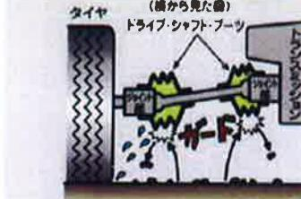
ドライブ・シャフトはトランスミッションやディファレンシャルからの動力をタイヤに伝える役目をしています。ドライブ・シャフトのジョイント部には、回転を円滑にするためにはペアリングが用いられており、これを潤滑するためにグリースが充填されています。それらを路面等の異物（ホコリ、石、水等）から守るために、ドライブ・シャフト・ダスト・ブーツで包んで保護しています。
